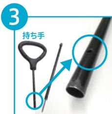
コントロールバー、持ち手の下部、プッシュピンを差し込む位置を確認します。○にプッシュピンの先端が出てきます。
