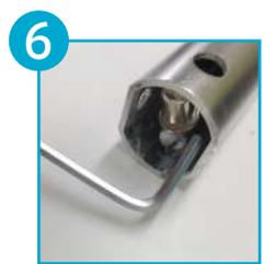
プッシュピンを正しい位置に戻してください。穴からピンの先端がしっかりと出るよう、細い工具などを用いて直してください。
