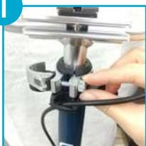
チューブクランプをゆるめます。レバーを開き、画像のように端の部分をつまみ反時計回りに回してゆるめます。
