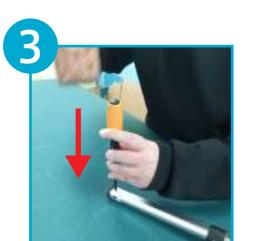
ドライバーをビスの先端に合わせ、ハンマーでたたきビスを押し出します。
