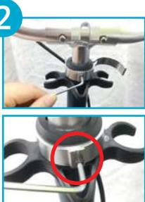
クランプレバーの裏側に、小さなネジ穴が見えます。2.5mm レンチを差し込み、中の小さなネジを取り外します。
