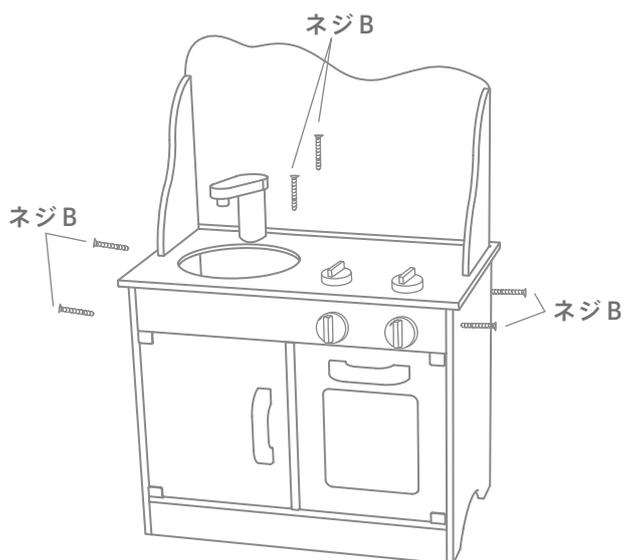
STEP5 の完成物の上に STEP1 の完成物を載せ、ネジ B で取り付けます。
