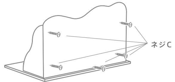
背面にフロントパネルをネジCで取り付けます。
