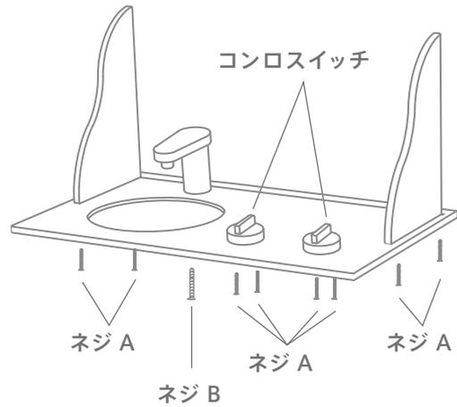
キッチン台にネジAを使って「コンロスイッチ」と「パネルA」を、ネジBを使って「蛇口」を取り付けます。
