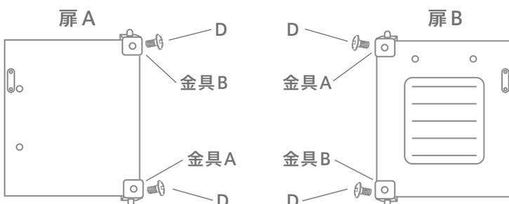
(1) 扉 A、扉 B を裏面にして、四隅に金具 A と金具 B をネジ D で取り付けます。
