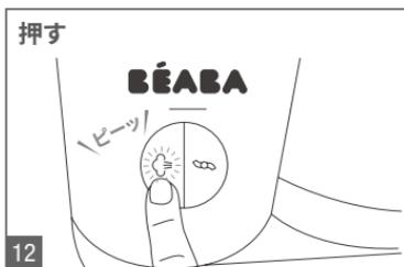
12 スチームボタンを1回押します。ピーツと音がしてスチームマークが点灯し、スチーム調理が開始されます。
