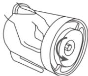
カッターのつまみを持ち、ガラスカップ内側から、底面の穴にカッターの下部を入れ、カッターの下部を左方向(反時計回り)に回して溝にはめ、カッターを固定します。
