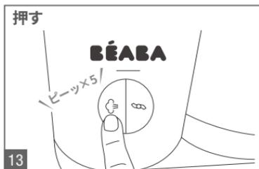
13 ウォータータンクが空になるとスチーム調理が終了し、ピーツと5回音がします。スチームボタンを1回押し、消灯させます。
