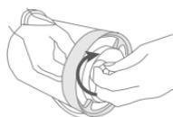
ガラスカップの内側に手を入れ、つまみを持ち、カッターの下部を右方向(時計回り)に回しながらガラスカップからカッターを外します。
